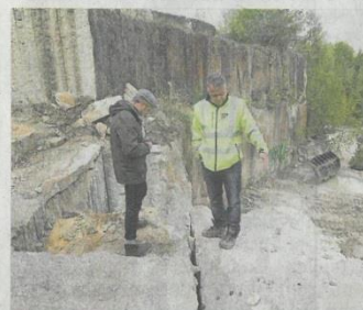
Produktionsleiter Uwe Jahr (r.) erläutert, wie man von der bereits gelösten Steinscheibe die einzelnen Klötze abspaltet.
